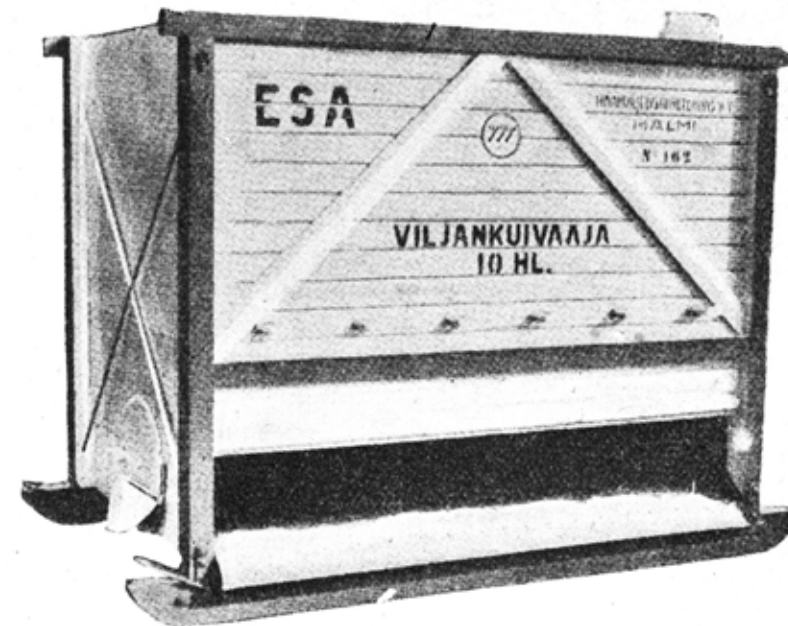
Kaappikuivuri Esa. Kuivauskaappi ja lämmityskamiina rakennettuna helposti liikuttavaksi kokonaisuudeksi.
